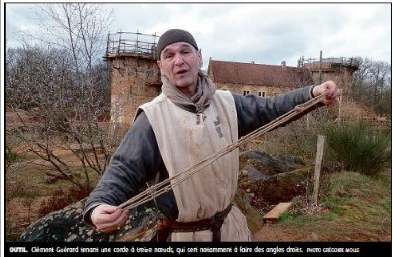
OUTIL. Clément Guérard tenant une corde à treize nœuds, qui sert notamment à faire des angles droits. PHOTO GRÉGOIRE MOLLE
